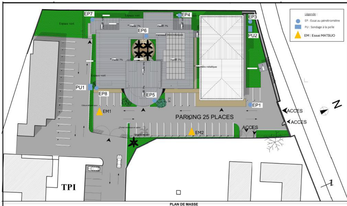
Figure 9 : Plan d'implantation des investigations réalisées en 2023 (G2 AVP) et en 2024 (G2 PRO)
